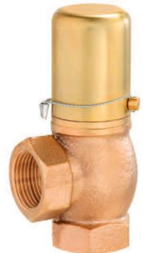
**Druckbegrenzungsventil Typ 618sGFO aus Rotguss, nicht bauteilgeprüft für Luft, neutrale Gase und technische Dämpfe sowie Wasser und neutrale Flüssigkeiten, -60°C bis 225°C**
