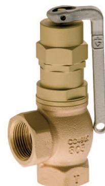
**Druckbegrenzungsventil Typ 618sGFL aus Rotguss, nicht bauteilgeprüft für Luft, neutrale Gase und technische Dämpfe sowie Wasser und neutrale Flüssigkeiten, -60°C bis 225°C**
